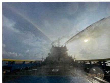
เรือสนับสนุน ภาพถ่ายที่ 2.2-28 อุปกรณ์ฉีดน้ำแรงดันสูง
