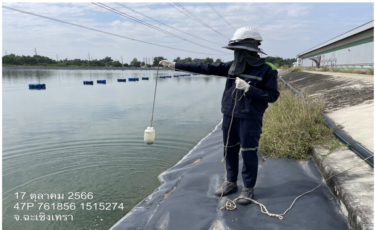
รูปที่ 3.4.4.1-2 การตรวจวัดคุณภาพน้ำ บริเวณบ่อพักน้ำทิ้ง 2
