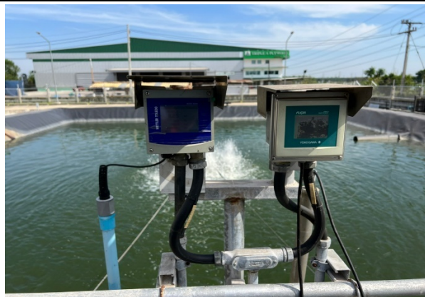
รูปที่ 2-5.2 (1) อุปกรณ์ตรวจวัดน้ำแบบ Online monitoring
