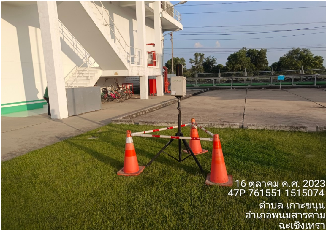
รูปที่ 3.4.3-2 การตรวจวัดระดับเสียงบริเวณริมรั้วโครงการติดตั้งทางหลวงหมายเลข 331
