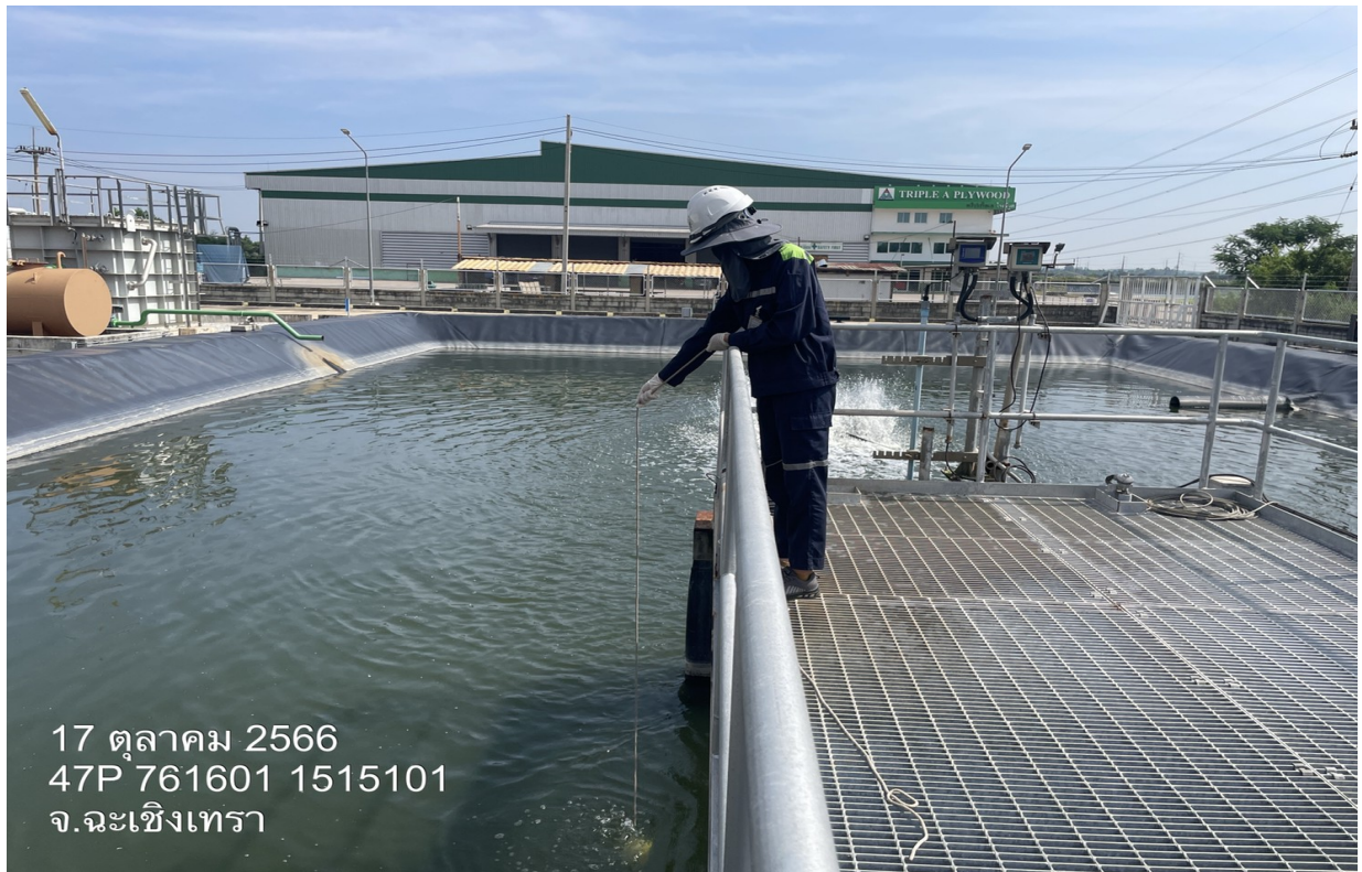
รูปที่ 3.4.4.1-1 การตรวจวัดคุณภาพน้ำ บริเวณบ่อพักน้ำทิ้ง 1
