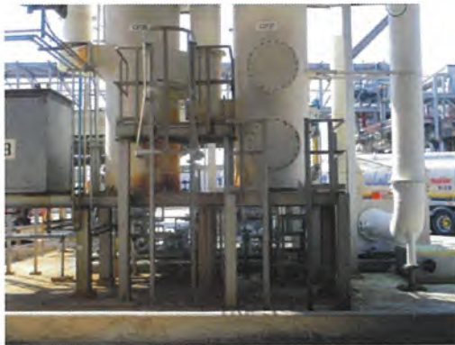
รูปที่ 3-36 Sulfur Scrubber
