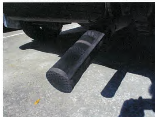
รูปที่ 3-57 อุปกรณ์ในการป้องกัน ไม่ให้เกิดประกายไฟจากท่อไอเสีย
