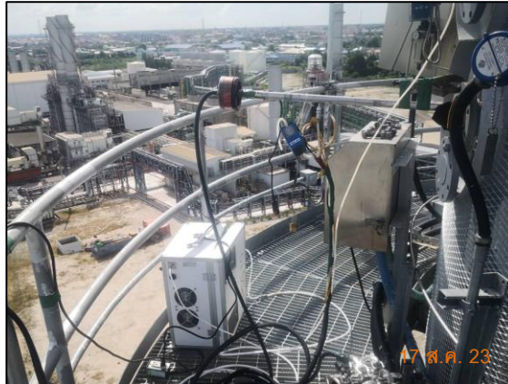
รูปที่ 3-2 การเก็บตัวอย่างคุณภาพอากาศในปล่องระบาย บริเวณ HRSG22
