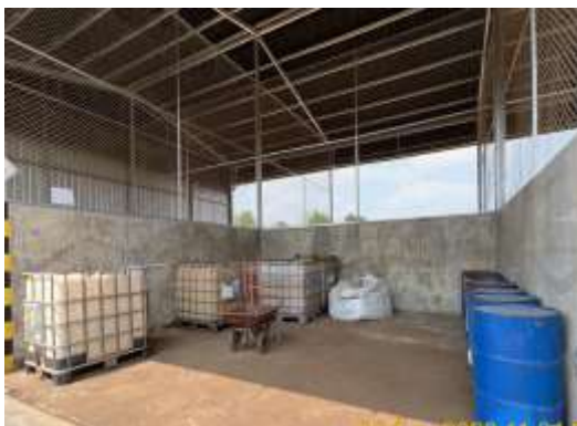
รูปที่ 73 ถังขนาด 200 ลิตร สำหรับจัดเก็บกระดาษกรองปนเปื้อนสารตะกั่วจากห้องปฏิบัติการ
