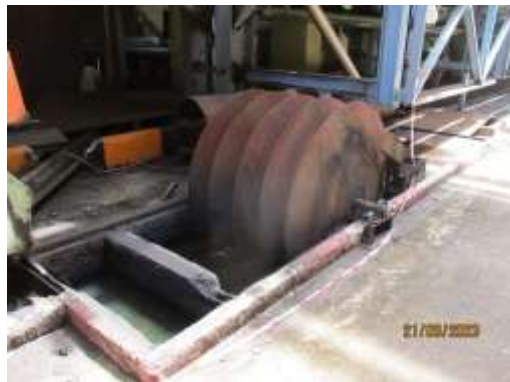
รูปที่ 37 บ่อแยกน้ำมัน (Oil Separator)
