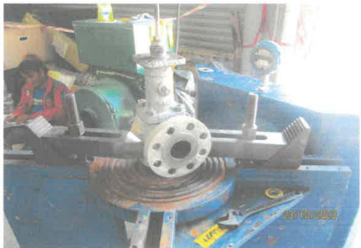
ตรวจสอบSafety Valve ต่างๆทำงานตามค่าที่กำหนด ด้วยเครื่องอัดตรวจสอบการทำงาน หม้อไอน้ำหมายเลข 6( HRSG-05 ) บริษัทสหโคเจน (ชลบุรี) จำกัด(มหาชน) วันที่ 23 ตุลาคม 2566
