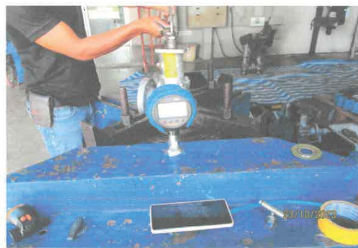
ตรวจสอบSafety Valve ต่างๆทำงานตามค่าที่กำหนด หม้อไอน้ำหมายเลข 6( HRSG-05 ) บริษัทสหโคเจน (ชลบุรี) จำกัด(มหาชน) วันที่ 23 ตุลาคม 2566
