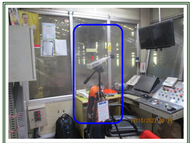
รูปที่ 4-91 ตรวจวัดระดับเสียงในพื้นที่การทำงาน บริเวณ Pendulum Shear (ห้องควบคุม) ตรวจวัดในวันที่ 19 ตุลาคม 2566
