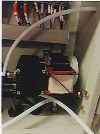
รูปแสดง Pump สำหรับทำ Auto Cal
