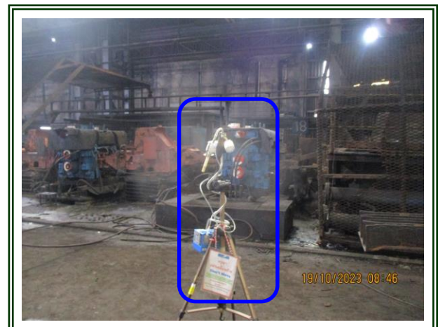
รูปที่ 4-61 ตรวจวัดฝุ่นละอองบริเวณแท่นรีดเหล็ก เก็บตัวอย่างในวันที่ 18-19 ตุลาคม 2566
