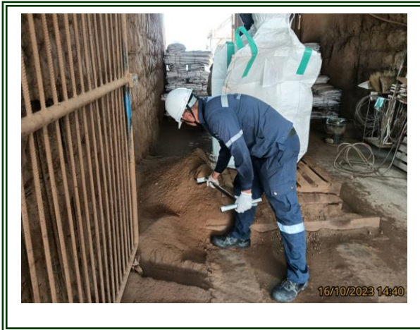
รูปที่ 4-58 เก็บตัวอย่างกากของเสีย ฝุ่นอัดเม็ด เก็บตัวอย่างในวันที่ 16 ตุลาคม 2566
