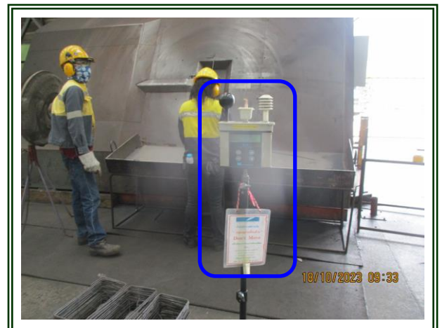
รูปที่ 4-69 ตรวจวัดระดับความร้อนบริเวณจุดผลิตเหล็กเส้นขึ้นรูป ตรวจวัดในวันที่ 18 ตุลาคม 2566
