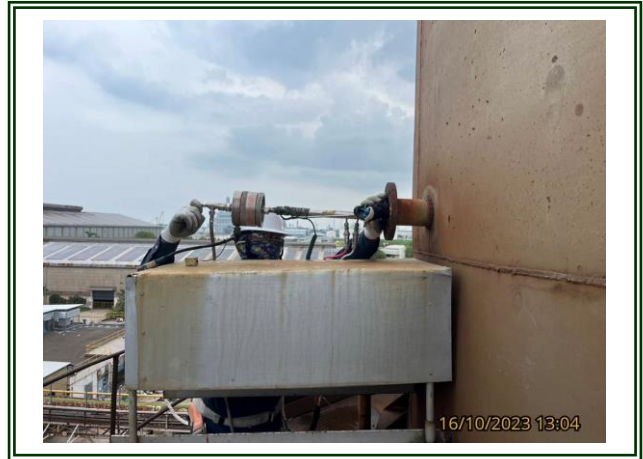
รูปที่ 4-47 ตรวจวัดปล่องที่ผ่านโรงกำจัดฝุ่น (Fume Plant # 1) ตรวจวัดในวันที่ 16 ตุลาคม 2566
