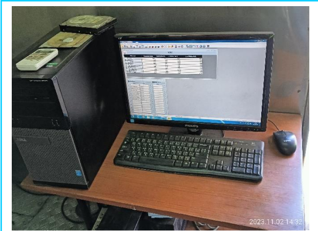
รูปที่ 3-6 คอมพิวเตอร์แสดงผลข้อมูลผลการตรวจวัดจากอุปกรณ์ตรวจวัดก๊าซแบบอัตโนมัติ (CEMs)
