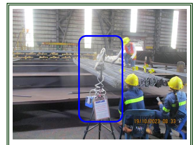
รูปที่ 4-63 ตรวจวัดฝุ่นละอองบริเวณลานนับเหล็กของผู้รับเหมา เก็บตัวอย่างในวันที่ 18-19 ตุลาคม 2566
