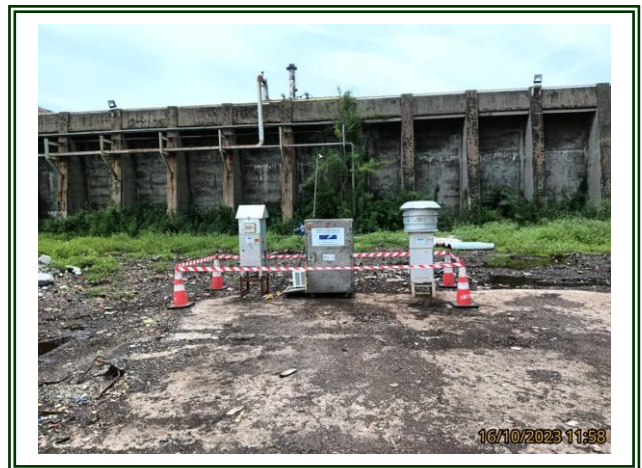
รูปที่ 4-53 ตรวจวัดคุณภาพอากาศในบรรยากาศโดยทั่วไป บริเวณริมรั้วโรงงานทางด้านทิศเหนือ ตรวจวัดระหว่างวันที่ 16-19 ตุลาคม 2566
