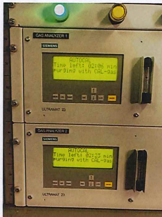
รูปแสดงหน้าจอ Gas Analyzer ระหว่างทำ Auto Cal
