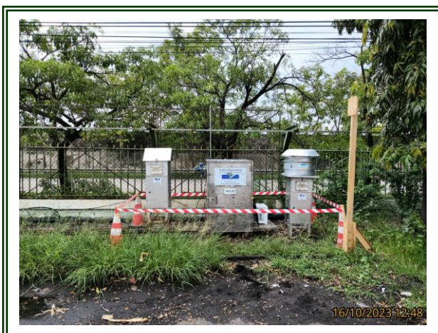
รูปที่ 4-54 ตรวจวัดคุณภาพอากาศในบรรยากาศโดยทั่วไป บริเวณริมรั้วโรงงานทางด้านทิศใต้ ตรวจวัดระหว่างวันที่ 16-19 ตุลาคม 2566
