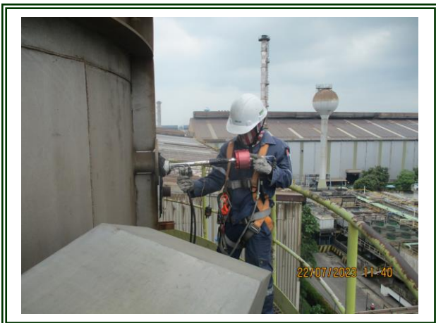
รูปที่ 4-48 ตรวจวัดปล่องที่ผ่านโรงกำจัดฝุ่น (Fume Plant # 2) ตรวจวัดในวันที่ 22 กรกฎาคม 2566
