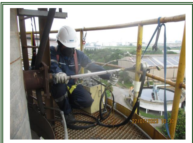
รูปที่ 4-50 ตรวจวัดปล่องของเตาอบเหล็กแท่ง (RHF) ตรวจวัดในวันที่ 22 กรกฎาคม 2566
