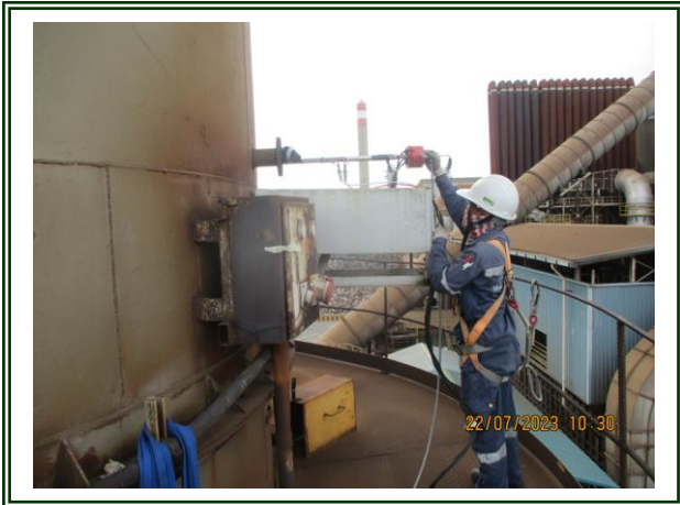
รูปที่ 4-46 ตรวจวัดปล่องที่ผ่านโรงกำจัดฝุ่น (Fume Plant # 1) ตรวจวัดในวันที่ 22 กรกฎาคม 2566
