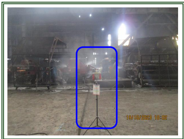
รูปที่ 4-66 ตรวจวัดระดับความร้อนบริเวณแท่นรีดเหล็ก ตรวจวัดในวันที่ 18 ตุลาคม 2566
