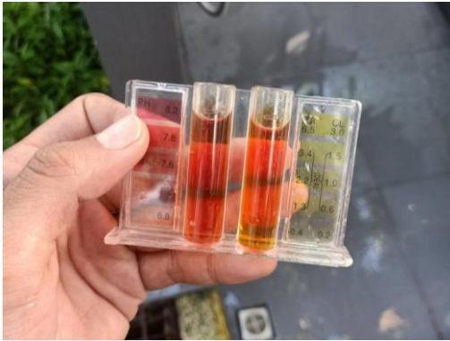
ภาพที่ 3.5.5-2 การตรวจวัด pH และ Cl 2 สระว่ายน้ำ
