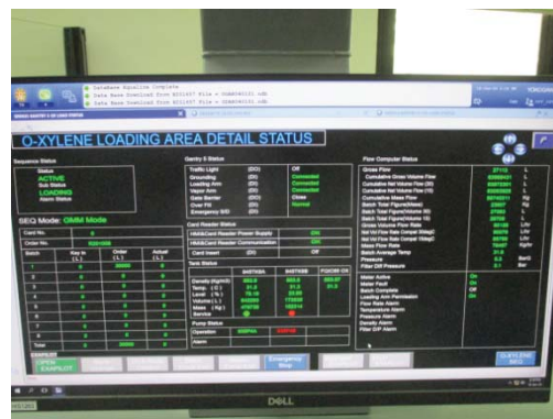
รูปที่ 3.1-1 (รูปที่ 7 หน้าจอควบคุมระบบไอ สารไอโธคาร์บอนด้วยโปรแกรม PLC)
