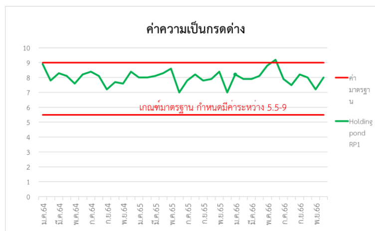
รูปที่ 3.21 ผลการตรวจวัดค่าความเป็นกรดด่าง (pH) บริเวณบ่อกักน้ำหล่อเย็นของโครงการทดแทนโรงไฟฟ้าพระนครใต้ ระยะที่ 1 ปี 2564-2566
