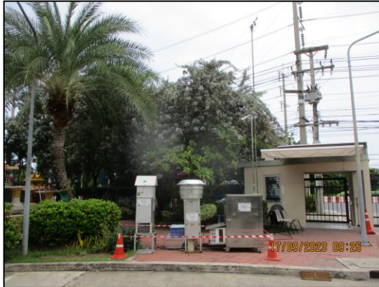
รูปที่ 3.4 การเก็บตัวอย่างคุณภาพอากาศในบรรยากาศ บริเวณ โรงเรียนสาธิตเกษตรฯ (A1)
