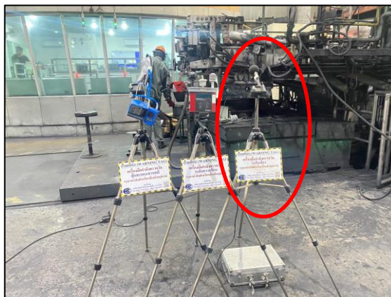
รูปที่ 3.13 การตรวจวัดระดับเสียงในพื้นที่ทำงาน บริเวณ เตาหลอม
