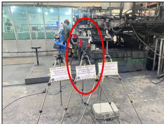
รูปที่ 3.16 การตรวจวัดระดับความร้อนในพื้นที่ทำงาน บริเวณ เตาหลอม
