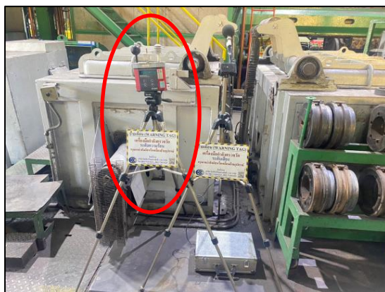
รูปที่ 3.17 การตรวจวัดระดับความร้อนในพื้นที่ทำงาน บริเวณ เครื่องอัดรีดร้อน
