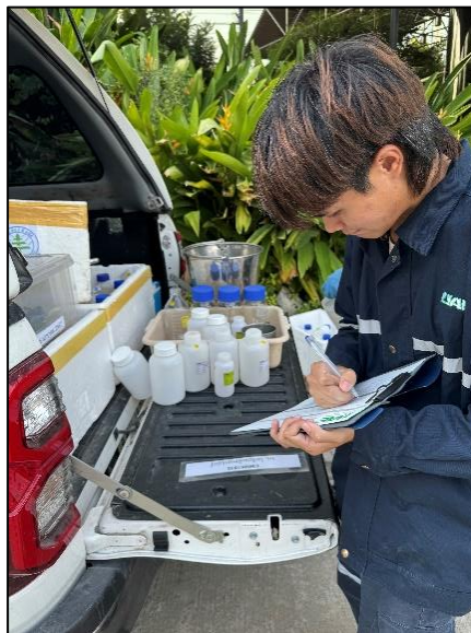
รูปที่ 3.10 การเก็บตัวอย่างคุณภาพน้ำทิ้งก่อนปล่อยออกนอกโครงการ บริเวณบ่อ Inspection Pit
