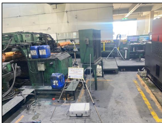
รูปที่ 3.14 การตรวจวัดระดับเสียงในพื้นที่ทำงาน บริเวณ เครื่องตัดท่อนทองแดง
