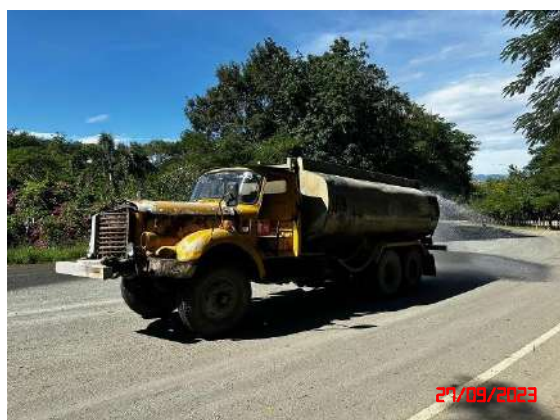
รูปที่ 5 การฉีดพรมน้ำภายในพื้นที่โครงการ
