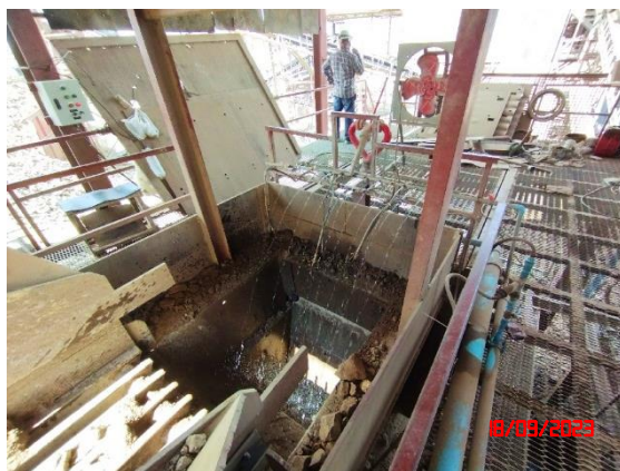
ระบบสเปรย์น้ำป้องกันฝุ่นละออง
