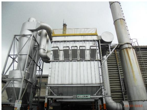
Cyclone อนุกรมกับ Bag Filter
