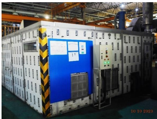
รูปที่ 9 ป้ายเตือนบริเวณพื้นที่ที่มีเสียงดัง และการจัดทำโครงการอนุรักษ์การได้ยิน รวมทั้งการติดตั้งที่ปิดครอบเครื่องจักรที่มีเสียงดัง
