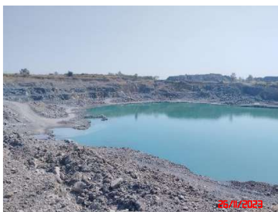
รูปที่ 13 บ่อรับน้ำ (Sump) ขุมเหมือง
