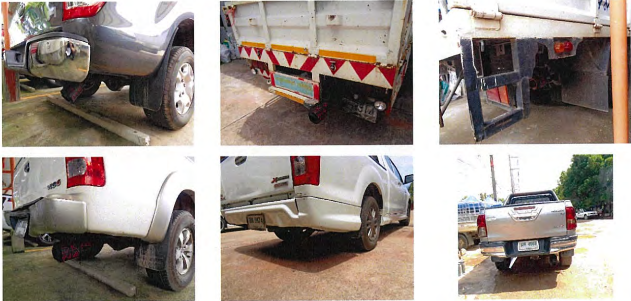
ภาพที่ 2.2-43 รถของผู้รับเหมาที่มีการติดตั้งอุปกรณ์ป้องกันประกายไฟ
