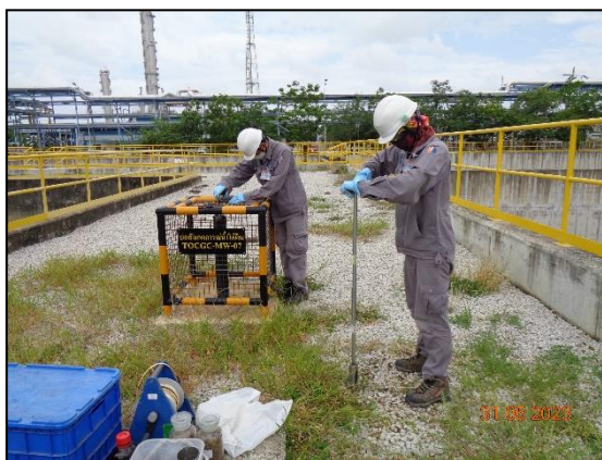
รูปที่ 4.14 การเก็บตัวอย่างดิน บริเวณ แนวท่อใต้ดิน
