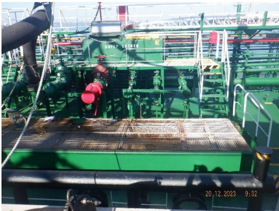
รูปที่ 2-19 ถาดรองรับน้ำมันที่อาจรั่วจากการต่อเชื่อมท่อสูญถ่าย
