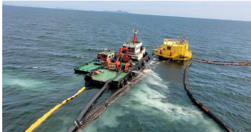
รูปที่ 2-21 การเก็บ/กำจัดคราบน้ำมัน
