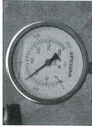
รูปที่ 64 Discharge Pressure ที่อ่านค่าได้เท่ากับ 104 psi.
