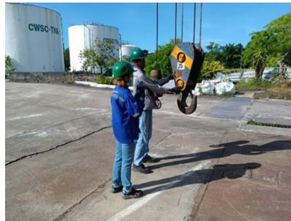
รูปที่ ข.1-43 การตรวจสอบอุปกรณ์การยกก่อนการใช้งาน
