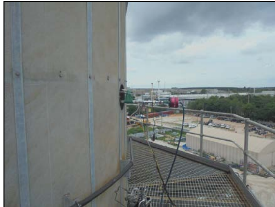
รูปที่ 3.1 การเก็บตัวอย่างคุณภาพอากาศในปล่องระบาย บริเวณ Main Stack HRSG 11
