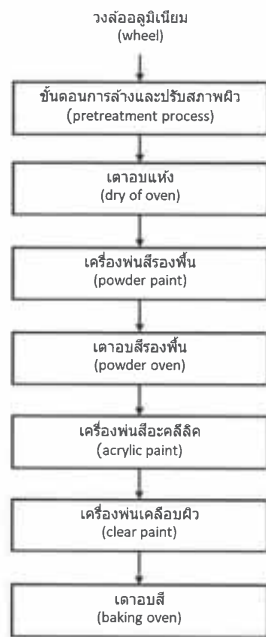
รูปที่ 1-2 ผังขั้นตอนส่วนการผลิตวงล้ออลูมิเนียมทำสีและกลึงเงา
