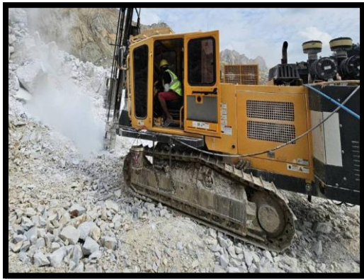
รูปที่ 2-25 รถเจาะมีหัวดักฝุ่น
