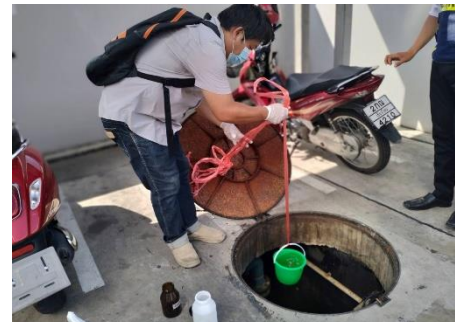
ภาพที่ 3-1 เก็บตัวอย่างคุณภาพน้ำทิ้งบริเวณน้ำทิ้งก่อนเข้าระบบ
