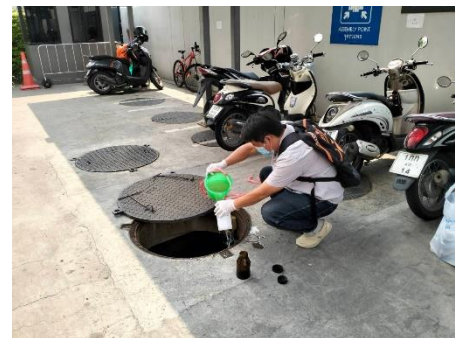
ภาพที่ 3-1 เก็บตัวอย่างคุณภาพน้ำทิ้งบริเวณน้ำทิ้งก่อนเข้าระบบ
