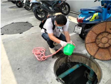
ภาพที่ 3-1 เก็บตัวอย่างคุณภาพน้ำทิ้งบริเวณน้ำทิ้งก่อนเข้าระบบ
