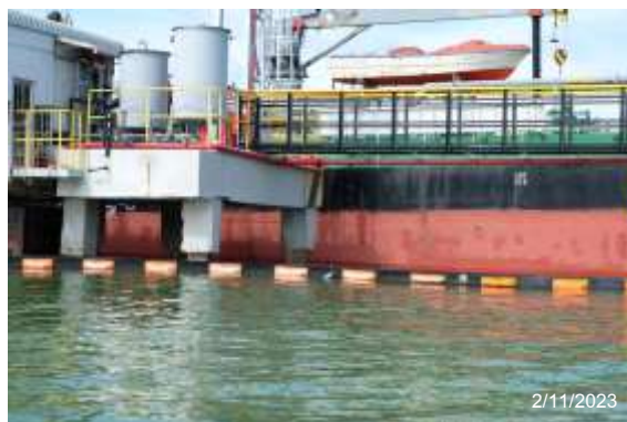
รูปที่ 2-5 (ต่อ) ที่กั้นเพื่อป้องกันการแพร่กระจายน้ำมันในกรณีเกิดการรั่วไหลลงทะเล
