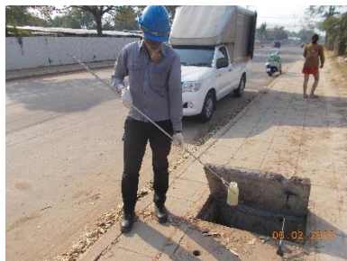
รูปที่ 3-3 การเก็บตัวอย่างคุณภาพน้ำทิ้ง ประจำเดือนกุมภาพันธ์ 2563
