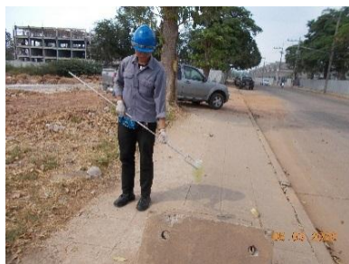
รูปที่ 3-4 การเก็บตัวอย่างคุณภาพน้ำทิ้ง ประจำเดือนมีนาคม 2563
