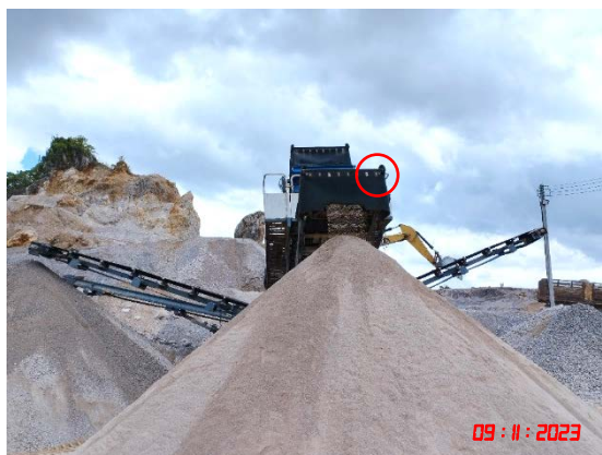
รูปที่ 25 ระบบเสาประจันน้ำบริเวณเครื่องจักรอุปกรณ์ในการบด ย่อยหินแบบเคลื่อนที่ได้
