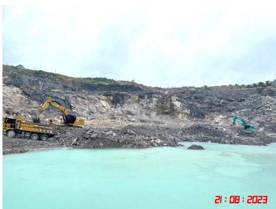
รูปที่ 14 บ่อรวบรวมน้ำ (Sump) ในชุมชนเหมือง
