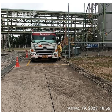
ภาพที่ 2-31 การสูบน้ำแอมโมเนียมไฮดรอกไซด์เหลว
