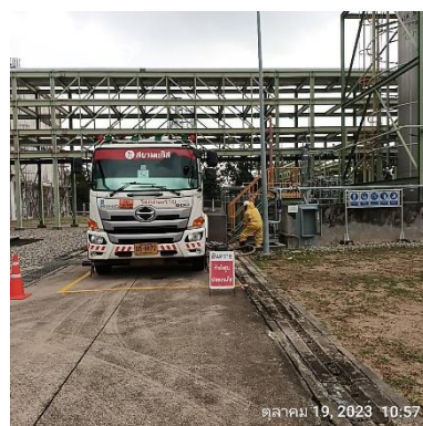
ภาพที่ 2-31 การสูบน้ำแอมโมเนียมไฮดรอกไซด์เหลว
