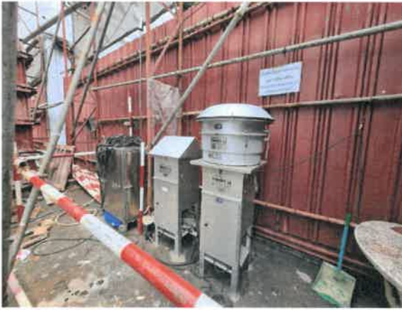
รูปที่ 2-29 แสดงการติดตั้งเครื่องตรวจวัดคุณภาพอากาศ เสียง และความสั่นสะเทือนไวภายในพื้นที่ก่อสร้าง และพื้นที่วิทยาลัยแพทยศาสตร์
