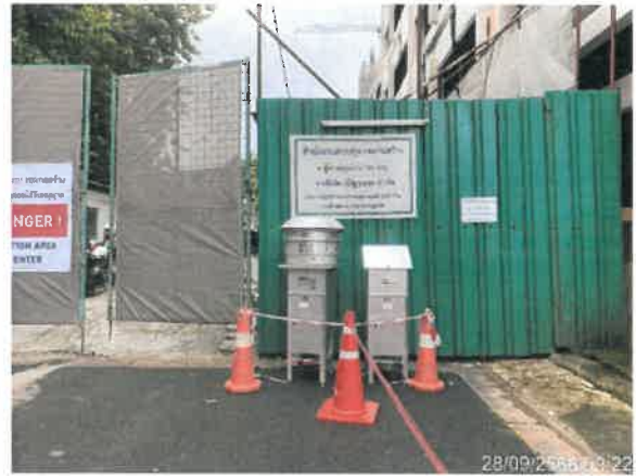
รูปที่ 2-29 แสดงการติดตั้งเครื่องตรวจวัดคุณภาพอากาศ เสียง และความสั่นสะเทือนไวภายในพื้นที่ก่อสร้าง และพื้นที่วิทยาลัยแพทยศาสตร์
