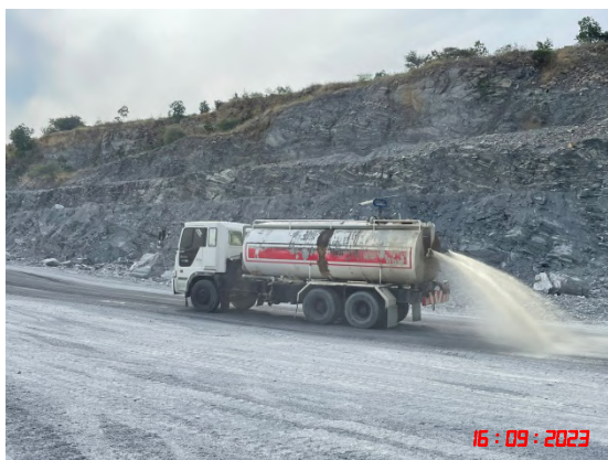
รูปที่ 4 การฉีดพรมน้ำบริเวณเส้นทางขนส่งแร่
