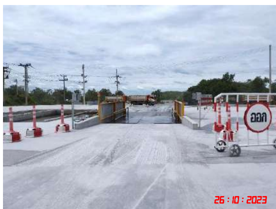
รูปที่ 18 บ่อล้างล้อรถบรรทุกแร่
