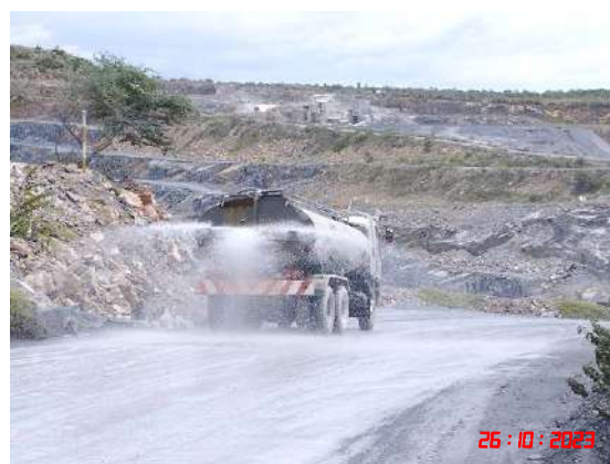
รูปที่ 15 การฉีดพรมน้ำบนเส้นทางขนส่งแร่
