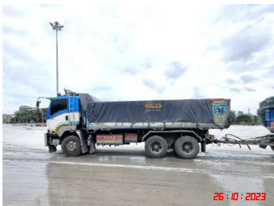
รูปที่ 16 การปิดคลุมผ้าใบรถบรรทุกแร่
