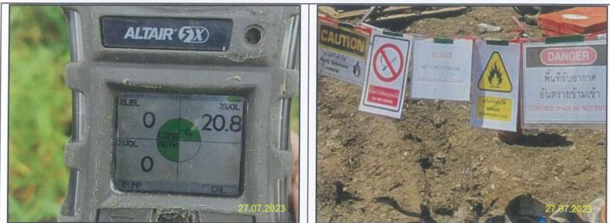
ตรวจสอบปริมาณ Lower Explosive Limit (LEL) ในท่อไม่ให้เกินร้อยละ 3 โดยปริมาตร
