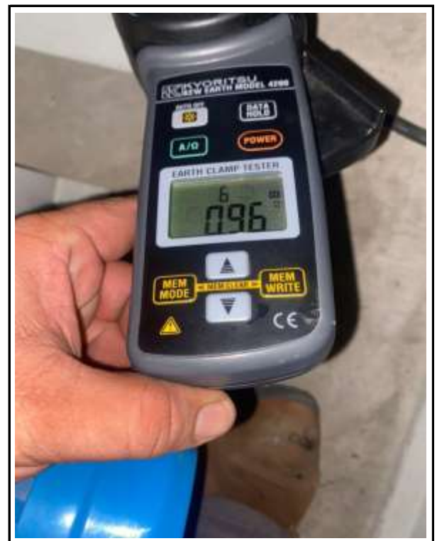
ตรวจวัดค่าความต้านทานดินของหม้อแปลงไฟฟ้า
