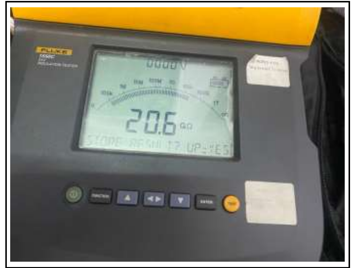
ตรวจวัดค่าความต้านทานฉนวนของชุดลวดหม้อแปลงไฟฟ้าแรงสูง
