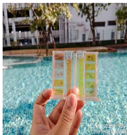
ภาพที่ 4.6.2 การตรวจวัด pH และ Free Chlorine สระว่ายน้ำ
