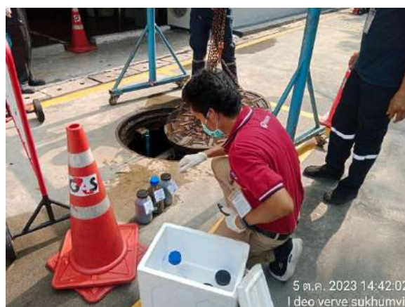
รูปที่ 4.1.1 การเก็บตัวอย่างคุณภาพน้ำทิ้ง
