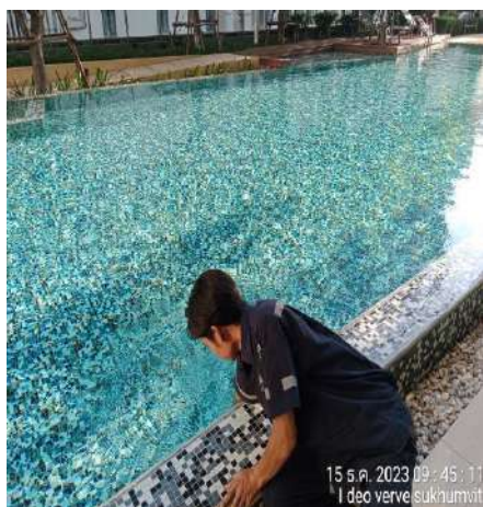
ภาพที่ 4.6.2 การตรวจวัด pH และ Free Chlorine สระว่ายน้ำ
