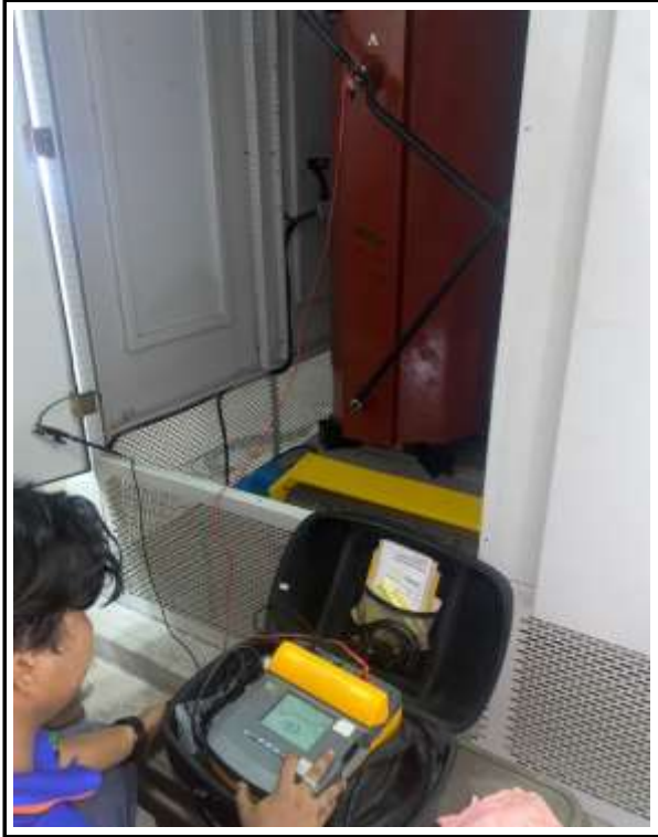
ตรวจวัดค่าความต้านทานฉนวนของชุดลวดหม้อแปลงไฟฟ้าแรงสูง
