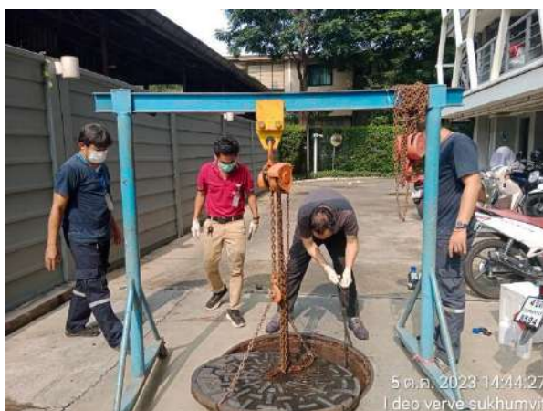
รูปที่ 4.1.1 การเก็บตัวอย่างคุณภาพน้ำทิ้ง
