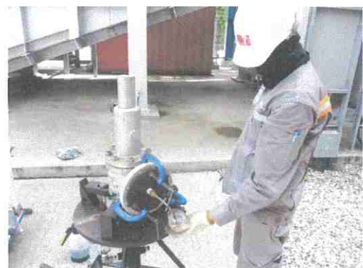
รูปที่ 5 การทดสอบการรั่วซึม / SEAT LEAKAGE TEST
