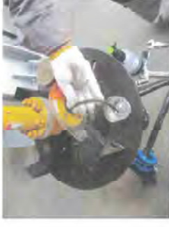
รูปที่ 5 การทดสอบความรั่วซึม / SEAT LEAKAGE TEST
