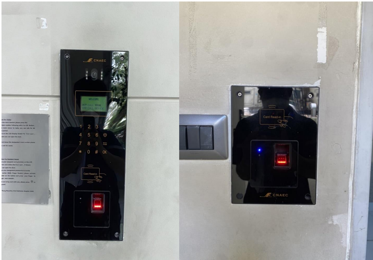
รูปที่ 43 ใช้ระบบแสกนนิ้วและบัตรเข้าภายในอาคาร
