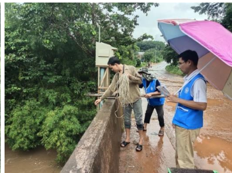
รูปที่ 5.2.2-16 การสำรวจรูปตัดขวางลำน้ำและสำรวจปริมาณน้ำ สถานี Kh.118 บ้านแก่งเต้ ตำบลบ้านค้อ อำเภอดำชะอี จังหวัดมุกดาหาร
