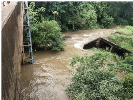
รูปที่ 5.2.2-16 การสำรวจรูปตัดขวางลำน้ำและสำรวจปริมาณน้ำ สถานี Kh.118 บ้านแก่งเต้ ตำบลบ้านค้อ อำเภอดำชะอี จังหวัดมุกดาหาร
