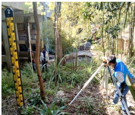
รูปที่ 5.2.2-17 การสำรวจรูปตัดขวางลำน้ำและสำรวจปริมาณน้ำ สถานี Kh.119 บ้านห้วยตาเปอะ ตำบลบ้านค้อ อำเภอดำชะอี จังหวัดมุกดาหาร
