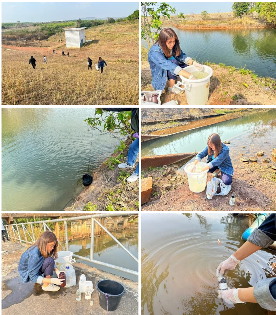
รูปที่ 5.2.4-3 การสำรวจและการเก็บตัวอย่างน้ำเพื่อวิเคราะห์คุณภาพน้ำผิวดิน วันที่ 15 มีนาคม 2566
