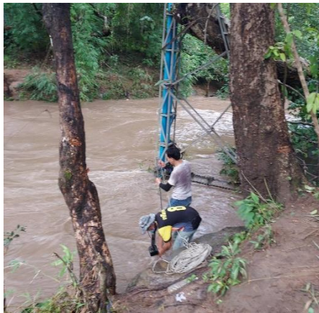
รูปที่ 5.2.2-16 การสำรวจรูปตัดขวางลำน้ำและสำรวจปริมาณน้ำ สถานี Kh.118 บ้านแก่งเต้ ตำบลบ้านค้อ อำเภอดำชะอี จังหวัดมุกดาหาร
