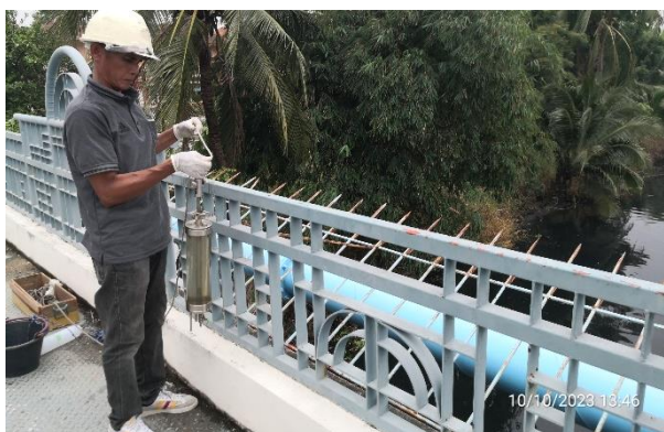
รูปที่ 3-2 การเก็บตัวอย่างน้ำผิวดินแหล่งรองรับน้ำทิ้งจากโครงการ
