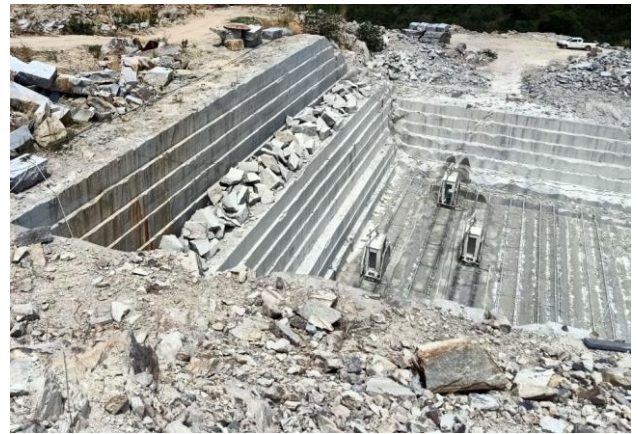
รูปที่ 2-2 ลักษณะการเปิดเหมืองแบบขั้นบันได
