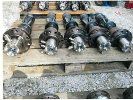
ภาพที่ 2-2 อุปกรณ์ Burner ในระบบหัวฉีดเผาไหม้ แบบ Dry Low NO x
