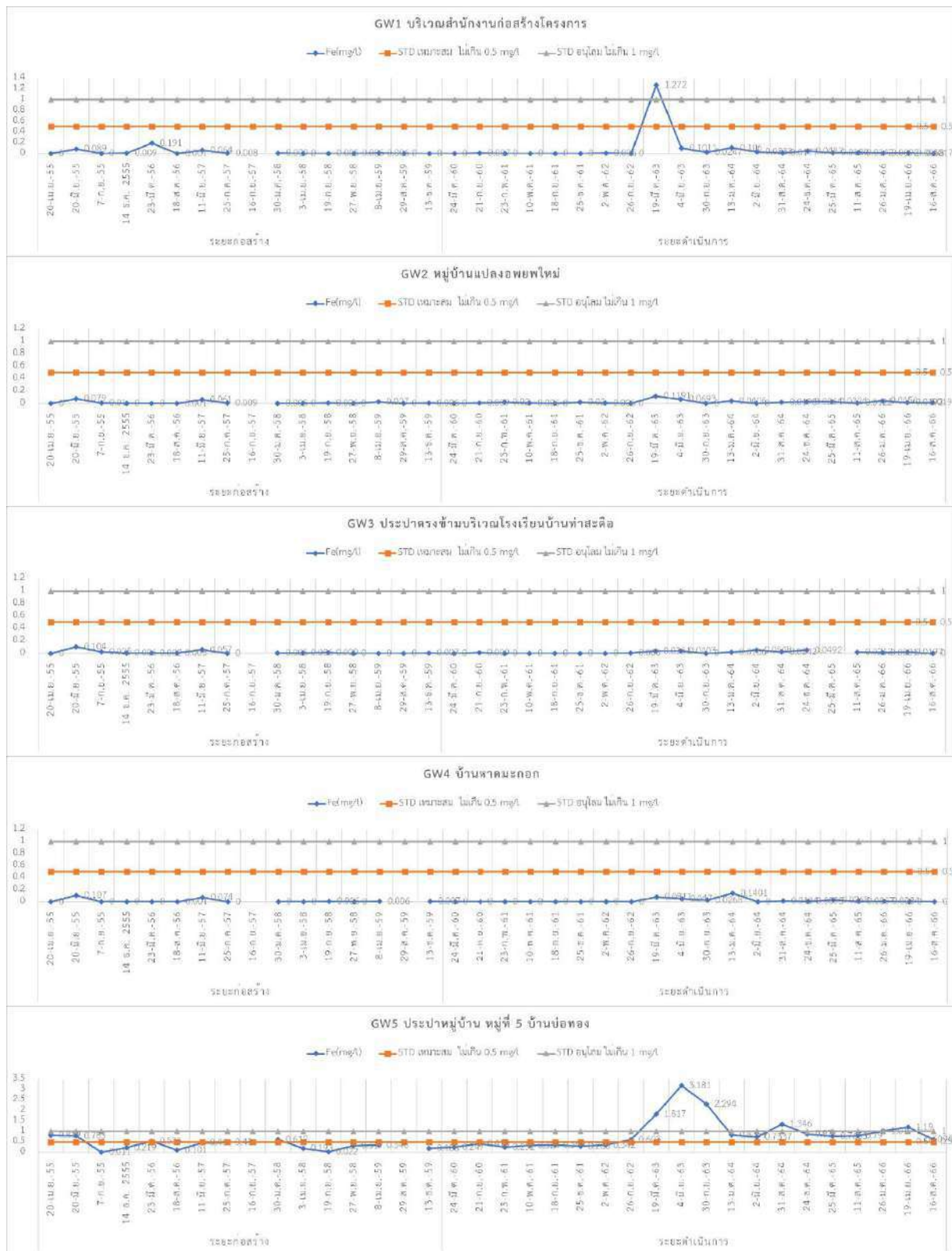
รูปที่ 5.2.3-38 กราฟเปรียบเทียบแสดงผลการตรวจวัดค่าเหล็ก (Fe) ของน้ำใต้ดินทั้ง 5 สถานี
