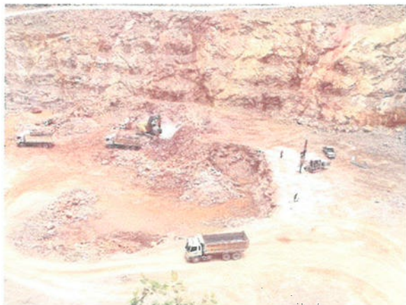
รูปที่ 1 การเปิดหน้าเหมืองเป็นชั้นบันได
