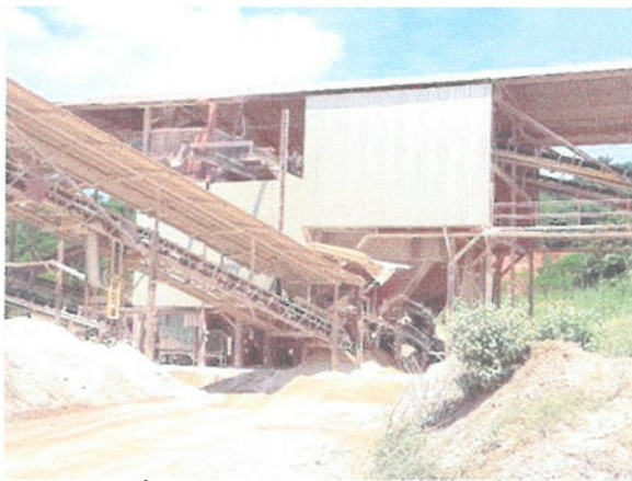
รูปที่ 14 การปิดคลุมอาคารโรงโม่หิน ชุด Secondary และ Tertiary Crusher
