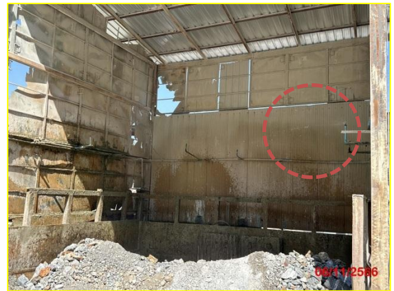
ภาพที่ 2-12 โรงโม่หินของโครงการปิดคลุม 3 ด้าน และการฉีดสเปรย์น้ำบริเวณปากโรงโม่
