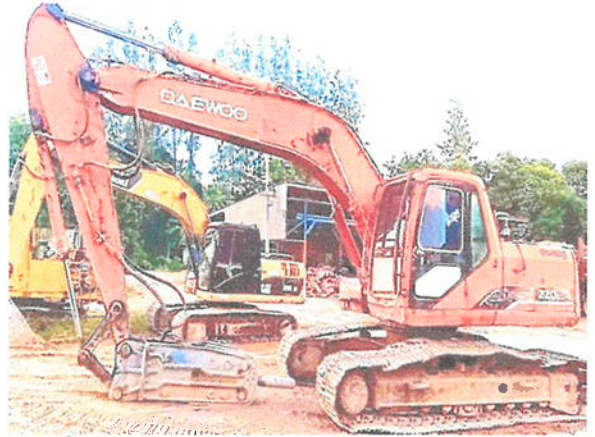
รูปที่ 4 เครื่องกระแทกหินแทนการระเบิดรอบสอง เพื่อความปลอดภัยในการระเบิด
