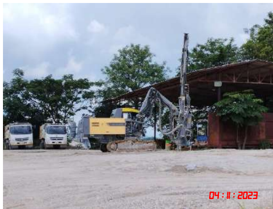
รูปที่ 4 รถเจาะรูระเบิดที่มีอุปกรณ์เก็บฝุ่นติดไว้กับหัวเจาะ
