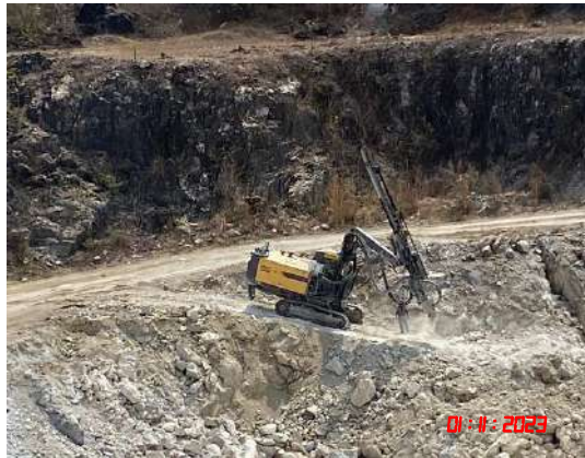
รูปที่ 18 เครื่องเจาะระเบิดที่มีการติดตั้งอุปกรณ์ดูดฝุ่นที่บริเวณหัวเจาะ
