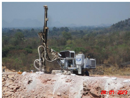
รูปที่ 20 เครื่องเจาะรูระเบิดที่มีอุปกรณ์เก็บฝุ่นติดไว้กับหัวเจาะ
