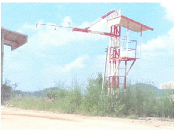
รูปที่ 21 ระบบสเปรย์น้ำบนกระบะรถบรรทุกหิน ก่อนเทหินลงปากโม่
