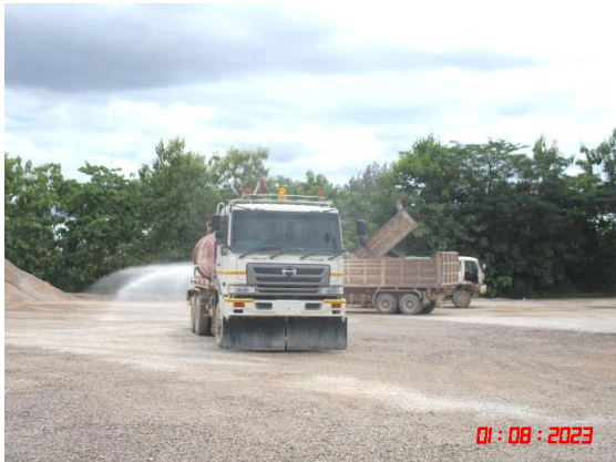
รูปที่ 6 การเก็บกวาดฝุ่นละอองในพื้นที่โรงโม่หิน
