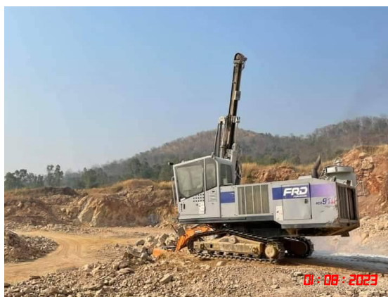
รูปที่ 17 เครื่องเจาะรูระเบิดที่มีอุปกรณ์เก็บฝุ่นติดไว้กับหัวเจาะ
