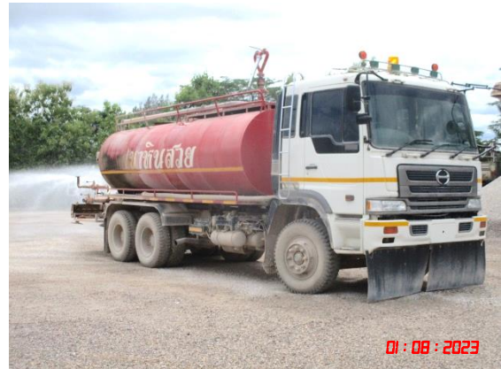
รูปที่ 6 การเก็บกวาดฝุ่นละอองในพื้นที่โรงโม่หิน
