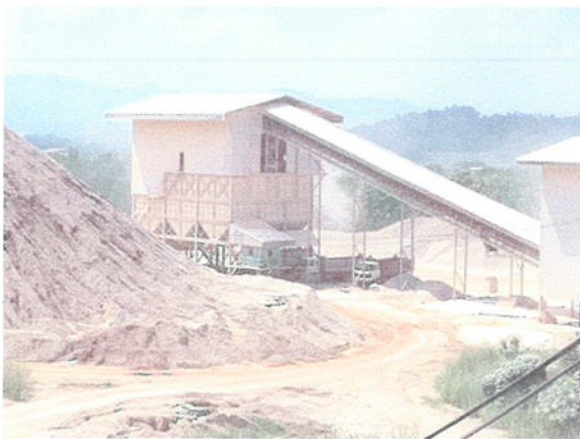
รูปที่ 14 การปิดคลุมอาคารโรงโม่หิน ชุด Product Screen
