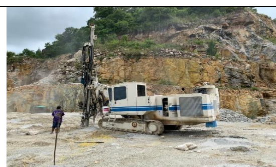
รูป V รถเจาะหินที่ติดตั้งเครื่องดูดฝุ่น
