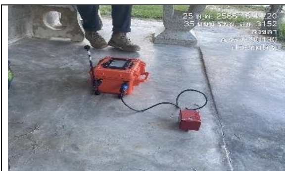
รูป AN ตรวจวัดแรงดันสะท้อนและแรงอัดอากาศจากการ ทำเหมือง จำนวน 2 สถานี
