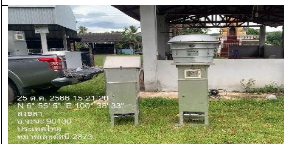
รูป AL ตรวจวัดปริมาณฝุ่นละอองรวม (TSP) และปริมาณ ฝุ่นละอองขนาดเล็กไม่เกิน 10 ไมครอน (PM10) จำนวน 4 สถานี
